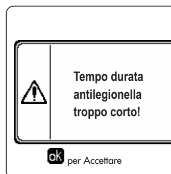
fig. 28 - Messaggio Funzione antilegionella non conclusa
